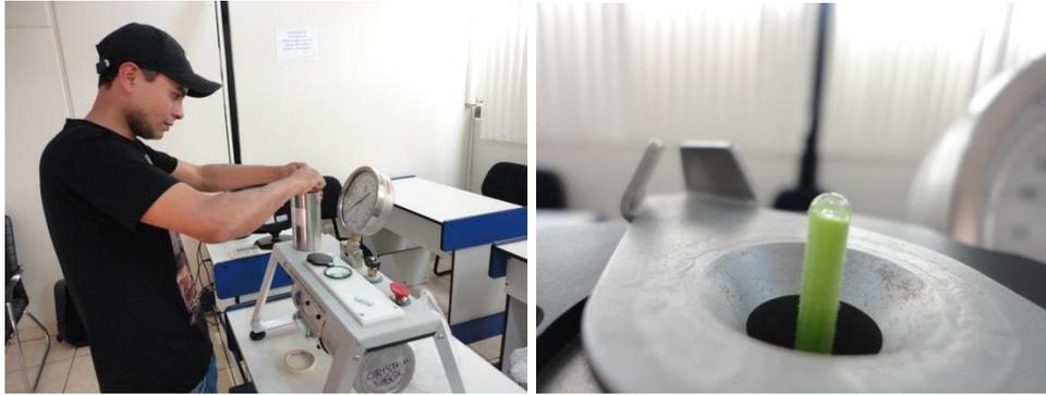
**Figura 4** - Medición del potencial hídrico xilemático en la hoja de frejol común con la bomba Schölander (derecha) y formación del menisco en el peciolo de la hoja cuando se equilibran las presiones del xilema con la del gas en el interior de la cámara (izquierda).
