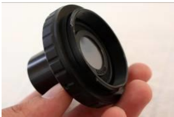
Figura 4 – Adaptador con la rejilla de difracción montada.
