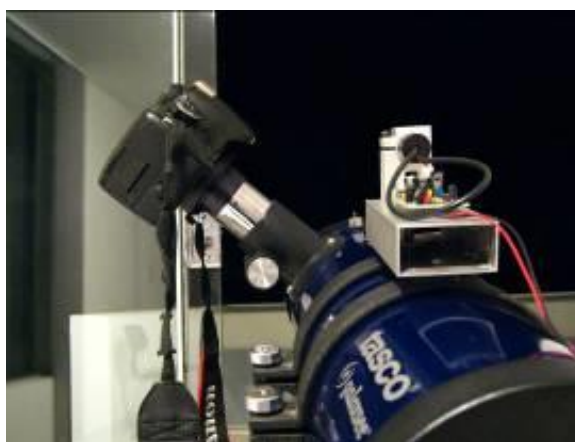
Figura 3 – Láser y cámara montados en el telescopio.
