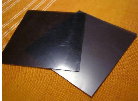
Figura 11 – Filtros usados en la medición de potencia de la luz retro dispersada
