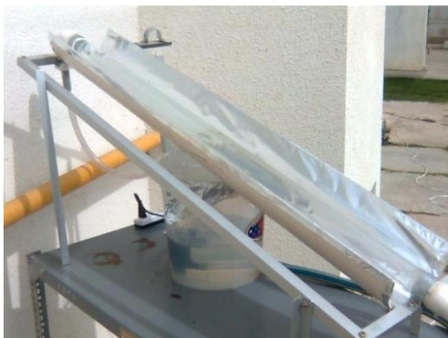
**Figura 1** - Fotoreactor solar tubular de sección semicircular de un solo eje.
