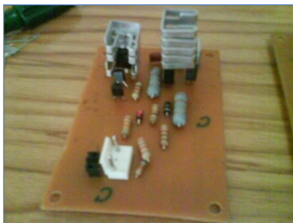
Figura 7 – Fotografía del regulador de voltaje.
