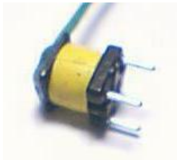
Figura 11 – Fotografía del transformador trigger .
