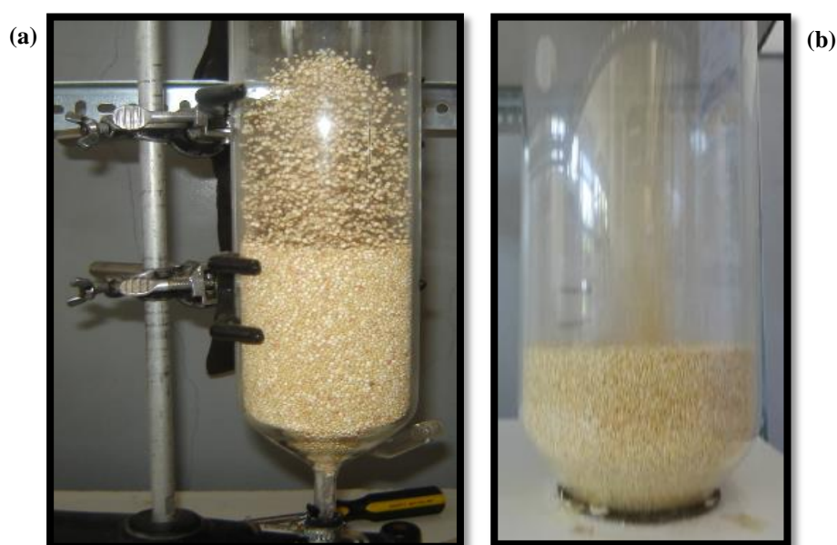
Figura 4- Comportamiento del surtidor generado ( h=12,5 cm; diámetro de boquilla = 3 mm). (a) Diámetro de lecho = 7,5 cm; (b) Diámetro de lecho = 20 cm.
