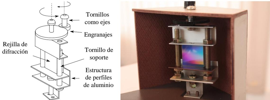
**Figura 3** – Montaje mecánico de rejilla de difracción (diseño y construcción).
