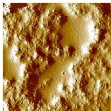
**Figura 6** – Imagen AFM de amplitud de AM y  $\beta\text{lg}$ , 2,5 % p/p materia seca, proporción AM: $\beta\text{lg}$  1:4, tamaño de barrido de 10  $\mu\text{m}$  y rango z de 1 V.
