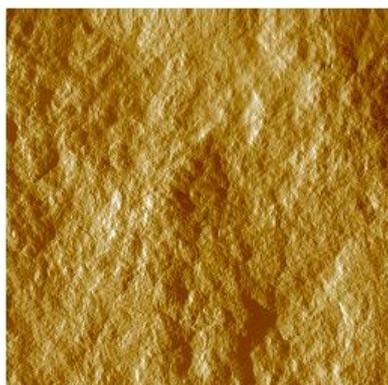
**Figura 5** – Imagen AFM de amplitud de AM y  $\beta\text{lg}$ , 2 % p/p materia seca, proporción AM: $\beta\text{lg}$  1:1, tamaño de barrido de 10  $\mu\text{m}$  y rango z de 0.5 V.
