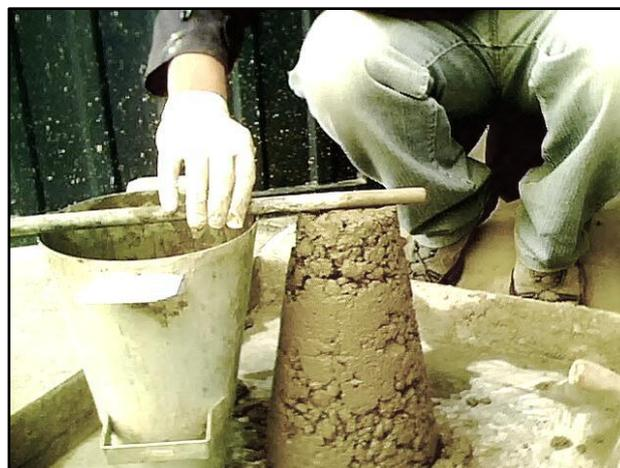
**Figura 9** – Concreto obtenido a partir del contenido de mortero seco y  $\alpha$  inicialmente asumidos.
