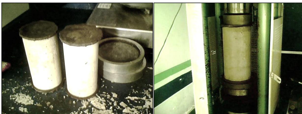
**Figura 13** – Preparación y ensayo a compresión de las probetas obtenidas.
