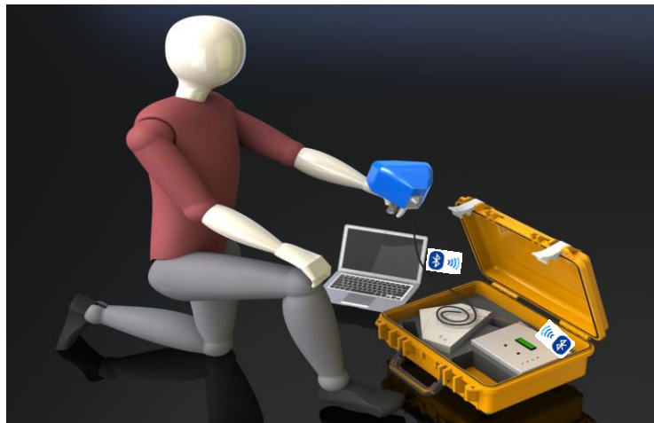
Figura 1 – Diseño conceptual de un sistema LIBS portátil.
