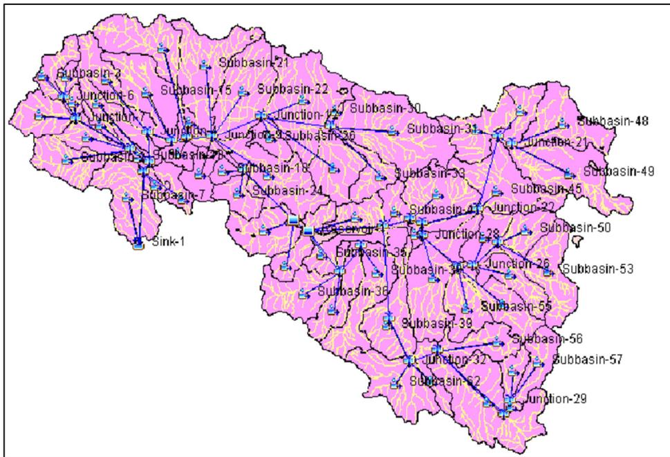
**Figura 5:** Esquema utilizado en el programa HEC-HMS.
