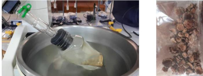
**Figura 1:** Equipo de síntesis de ferrato de potasio y gránulos producidos.
