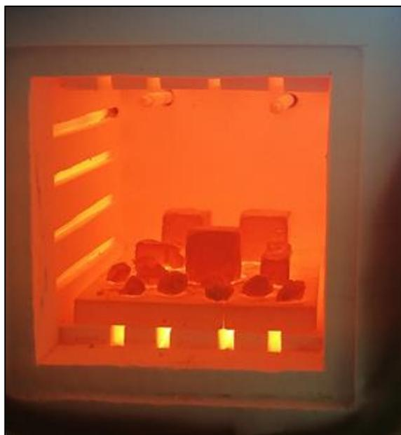
**Figura 8:** Quema de muestras de diatomita en horno de mufla.
