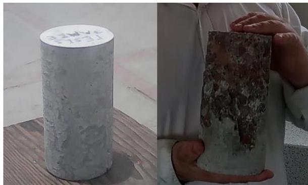
**Figura 12:** Probeta de hormigón con agregados de diatomita antes y después del ensayo a compresión,  $f'_c=23.5 \text{ Mpa}$ .
