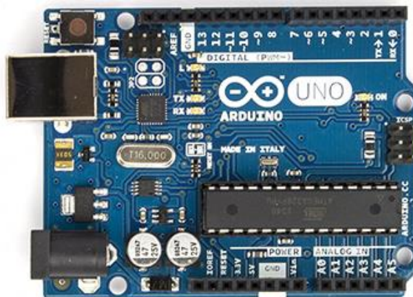
Figura 6 - Placa Arduino Uno R3 presentada por el fabricante.
