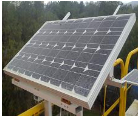
Figura 2 - Panel Fotovoltaico SUNTECH-STP030-12.
