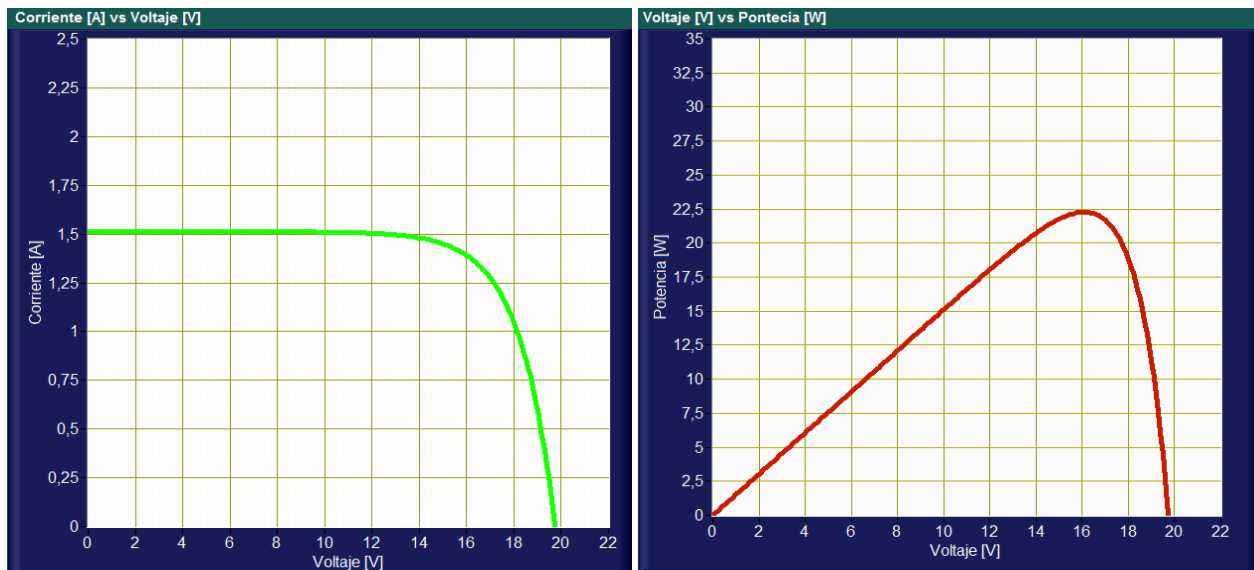
Figura 20 - Curva I-V (derecha) y relación de voltaje respecto a la potencia obtenida del panel fotovoltaico a una radiación solar de 750 \text{ W/m}^2 y una temperatura de 24 \text{ }^\circ\text{C} .
