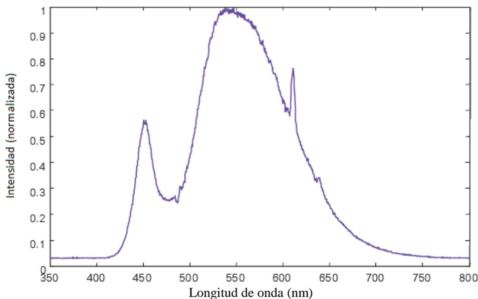
**Figura1** – Espectro de emisión óptica de un LED (fosforo-amarillo/azul).
