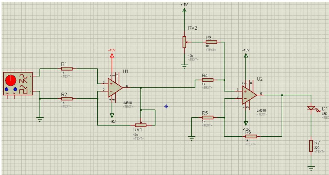
Figura 4 – Circuito transmisor para la transmisión de video compuesto.
