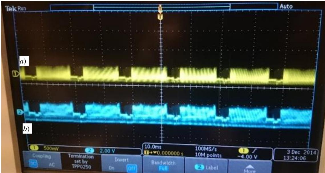
**Figura 10** – Señal original de entrada al Transmisor (a), señal de salida del Receptor Óptico (b).
