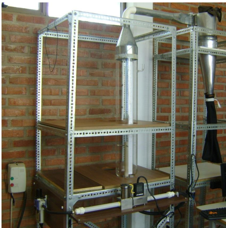
Figura 1: Equipo experimental: (a) regulador de presión y filtro; (b) medidor de flujo; (c) reactor cilíndrico-cónico de 14,34 cm de diámetro interno; y (d) sistema de recolección de material particulado fino.
