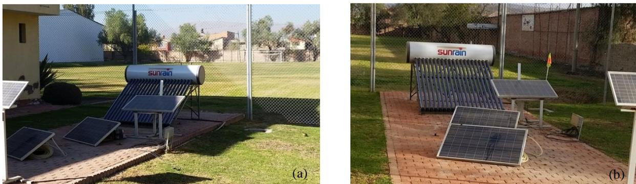
Figura 11 - Energía solar perdida debido a sombras en el colector solar térmico por la mañana (a) y por la tarde (b)
