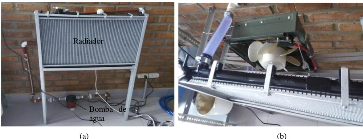
**Figura 8** – Vista del radiador, la bomba de agua (a) y del ventilador de aire (b) del sistema de calefacción solar térmico.
