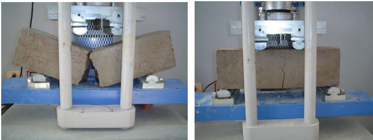
Figura 6 – Rotura de viga después del ensayo a flexión: a) sin fibra y b) con fibra, respectivamente.
