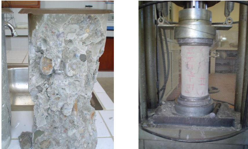
Figura 3 – Rotura de cilindros de hormigón simple y con fibra después del ensayo a compresión.
