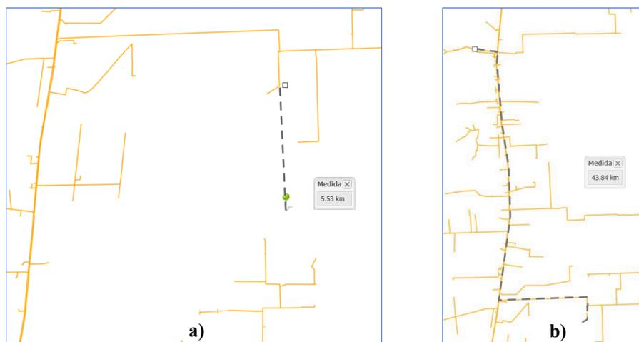
**Figura 4:** a) Distancia de Ampliación de Red (5.53 km), b) Distancia a la Subestación (43.84 km)
